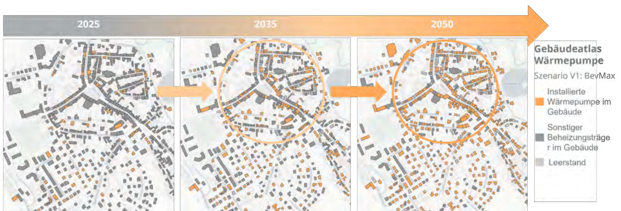
Abbildung 4.4: Simulierter Wärmepumpen-Zubau im Gebäudebestand der Stadt im Szenario V1: BevMax für die Jahre 2025, 2035 und 2050 für einen beispielhaften Simulationsdurchlauf. Die Darstellung basiert auf einer realisationsbezogenen Simulation und berücksichtigt nicht die Streuung bzw. Unsicherheit aus der zugrunde liegenden Wahrscheinlichkeitsverteilung. Quelle: Eigene Darstellung
